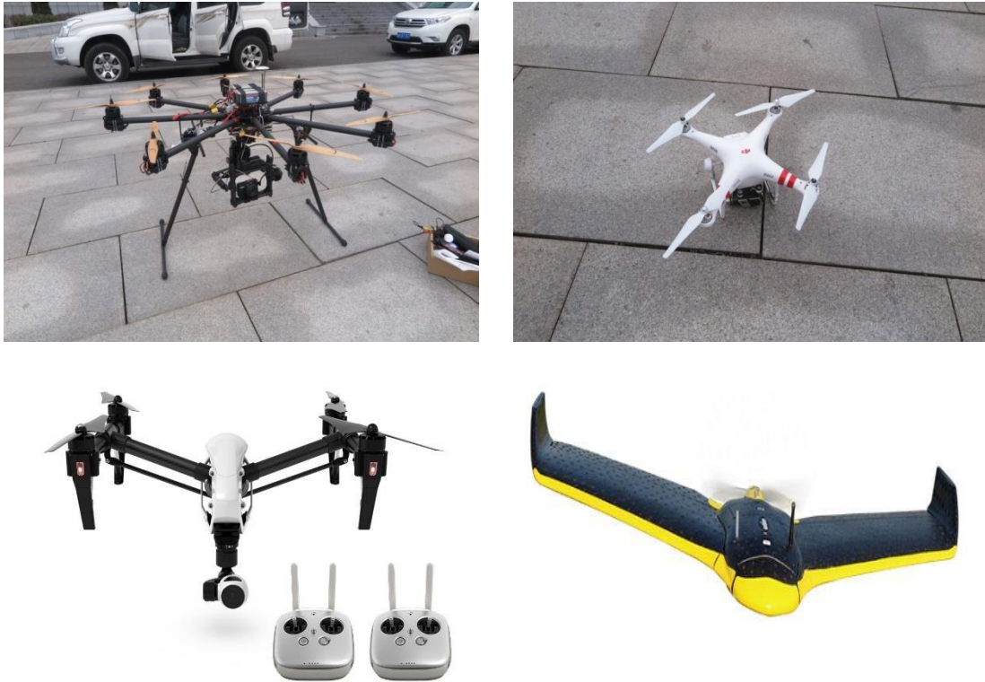
图 2-3 8 轴无人机、4 轴无人机和 ebee 无人机
