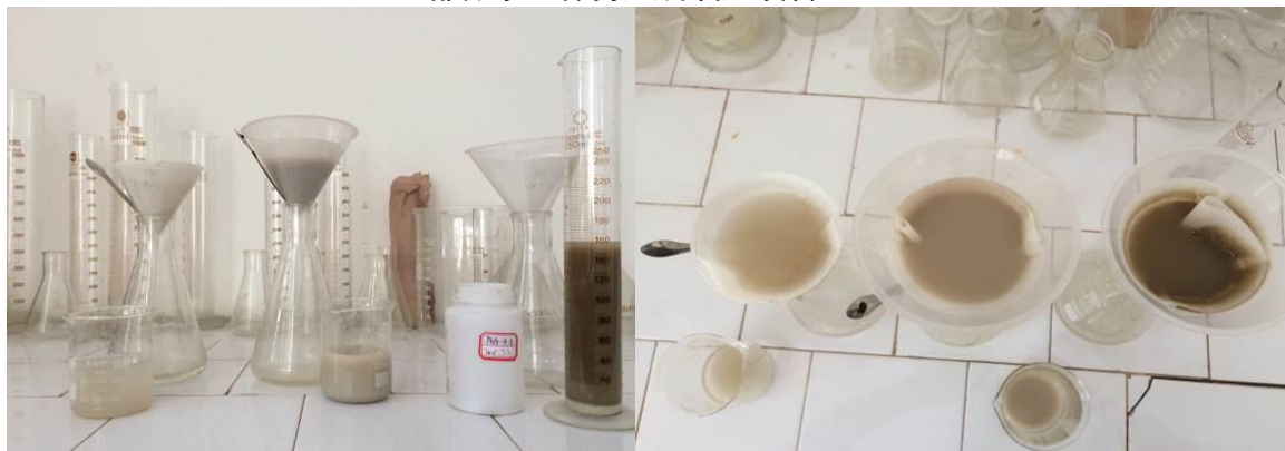
实验室泥沙含量测定
