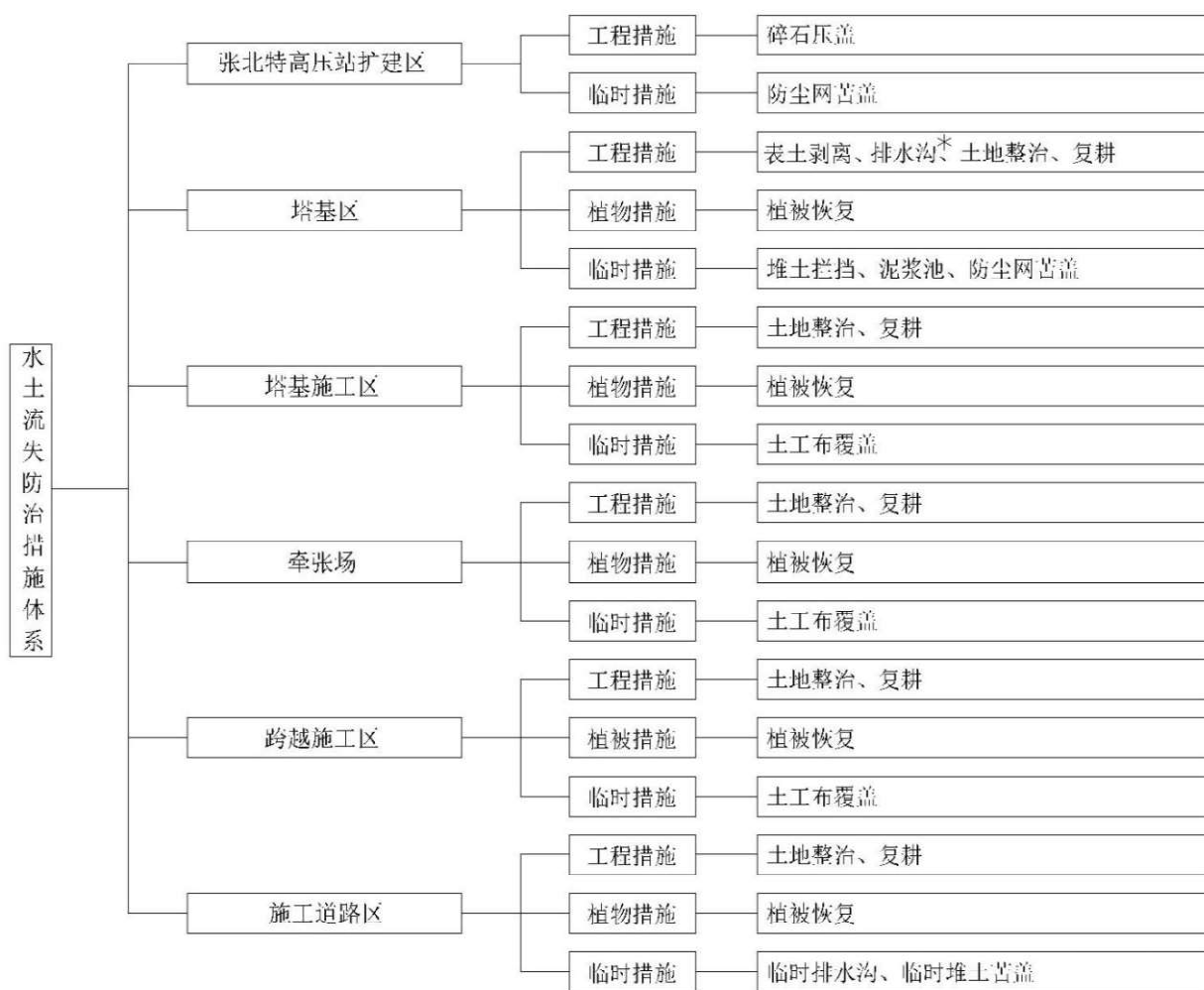
图 3-1 方案设计水土流失防治措施体系框图
