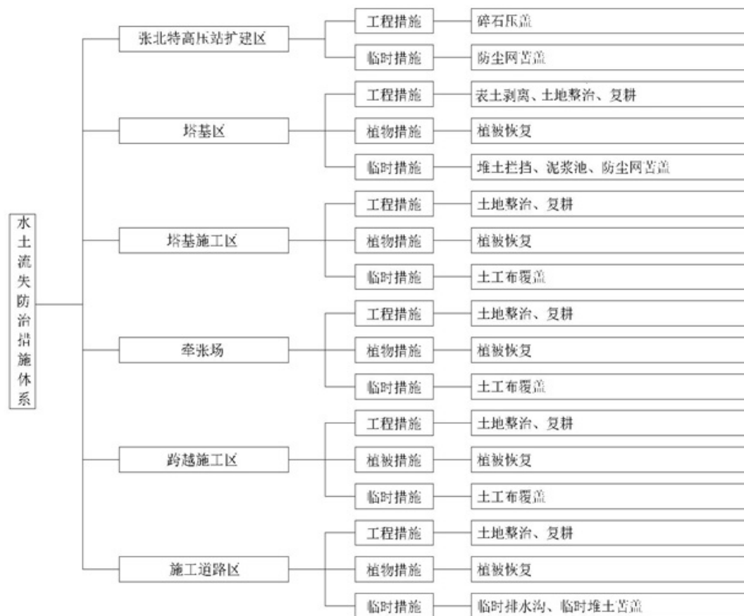
图 3-2 实际实施水土流失防治措施体系框图
