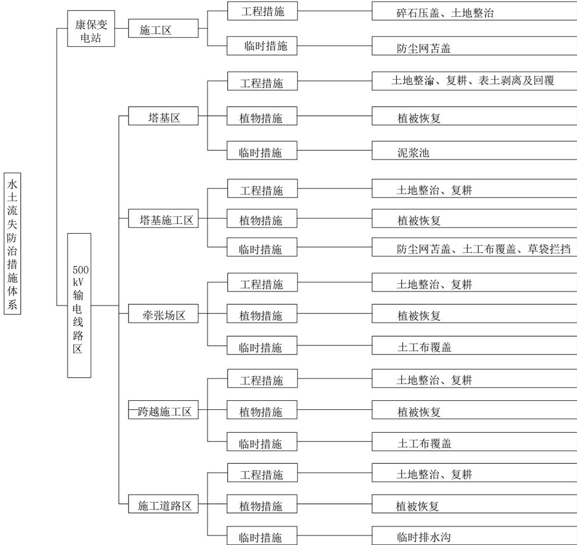
对比图 3-1 和图 3-2，工程实际实施的各防治分区水土保持措施布局基本上与方案设计一致，其中排水沟由于塔基微地貌均为平原，无汇水面积，无聚集排水而取消。水土保持措施体系合理的。
